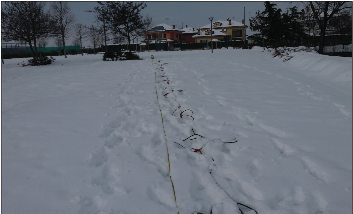
Foto 2: Prova sismica MASW S1.
