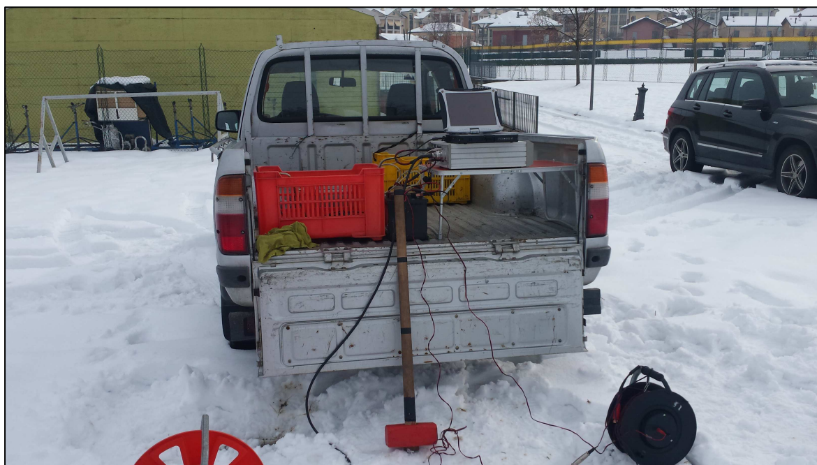
Figura 7.2 – Vista dello stendimento S1 impiegato per l’acquisizione della prova MASW.
