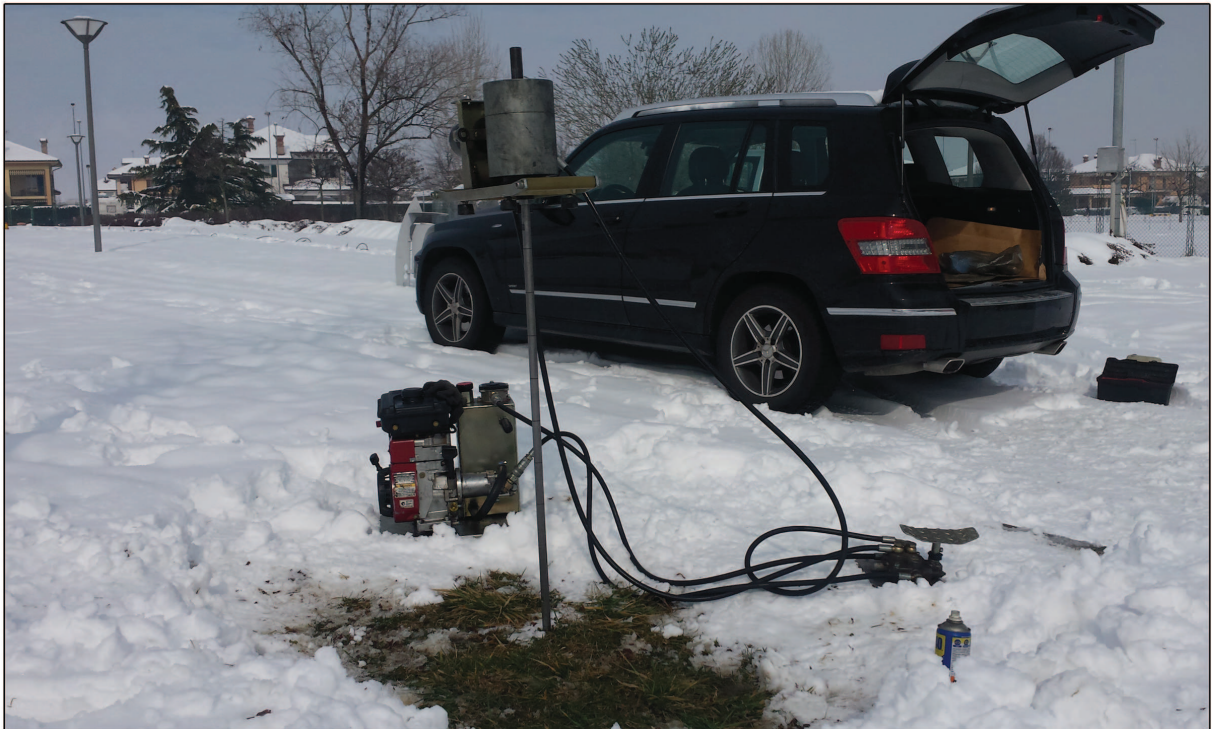
Foto 1: Prova penetrometrica dinamica P1.
